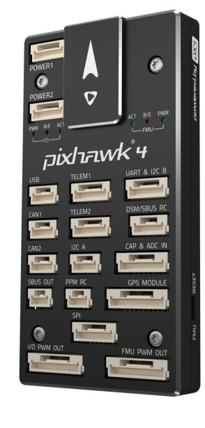
PX4는 무인항공기의 원격조정 및 자율주행을 위해 설계된 플라이트 컨트롤러이다. 배터리, ESC, GPS, IMU, 모터를 이용한 멀티콥터의 제어를 담당한다.
